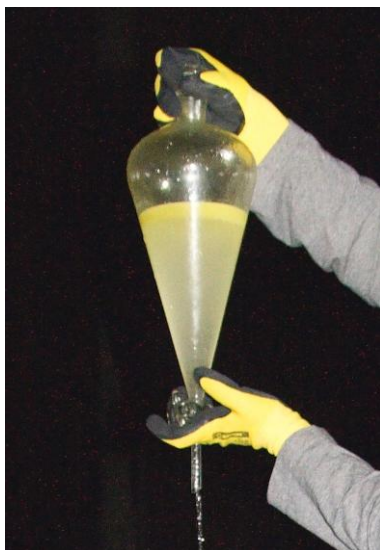
Obr. 1 Vypouštění vody po separaci fází po sedmé extrakci. V důsledku hydrolyzy je vodní fáze mléčně zakalená, olivový olej tvoří vrstvu na hladině.
